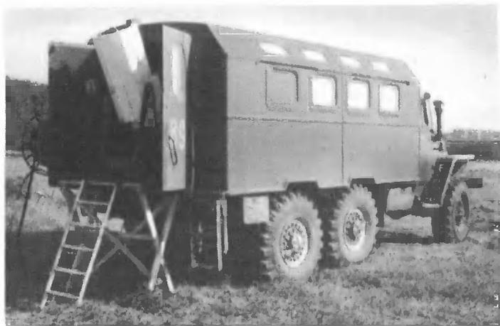
Передвижная установка для лазерного зондирования атмосферы. На этом лидаре можно регистрировать высотный профиль концентрации аэрозолей в атмосферном столбе высотой 2 км и проводить бесконтактный спектральный анализ газообразных примесей на расстоянии до 300 м; угол обзора лидара 90°.
